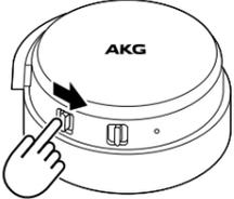
③ 以下の説明を参照し、デバイス側でペアリング操作を行い、登録 / 接続する。ペアリングが完了すると、インジケータがゆっくり点滅します。
